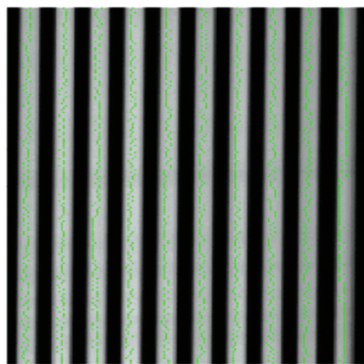
图 5 灰度值重心法标记光纤光谱中心(局部放大)
