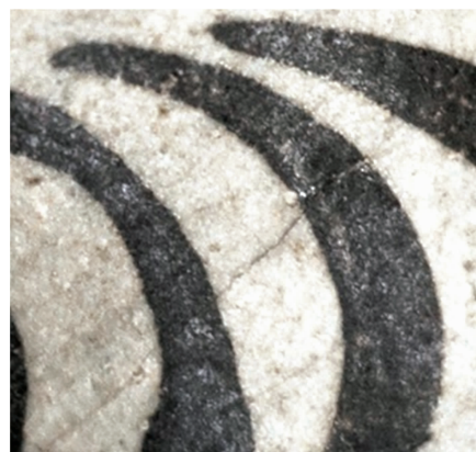
图 13 古陶瓷样品表面目标扫描区域(10 mm×10 mm)
