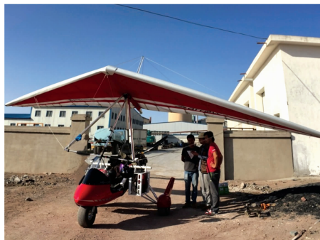
图 1 动力三角翼搭载 HySpex 高光谱传感器 Fig. 1 Dynamic triangular wing mounted HySpex hyperspectral sensor
