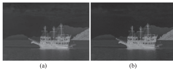
图 4 (a) 红外成像系统拍摄图; (b) CLAHE 算法去雾效果图
