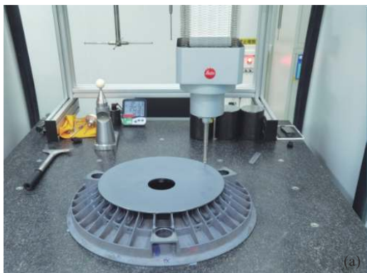
图 8 三坐标测量机 (a) 与轮廓仪测试现场 (b)
