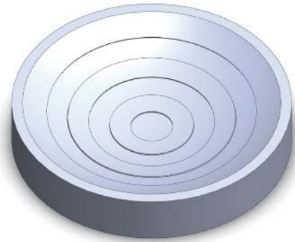
图 1 球面台阶测试板结构图
