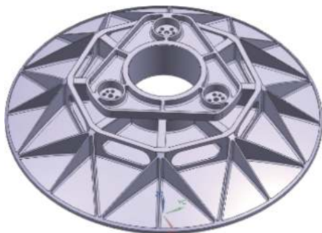
图 3 反射镜背部轻量化结构
