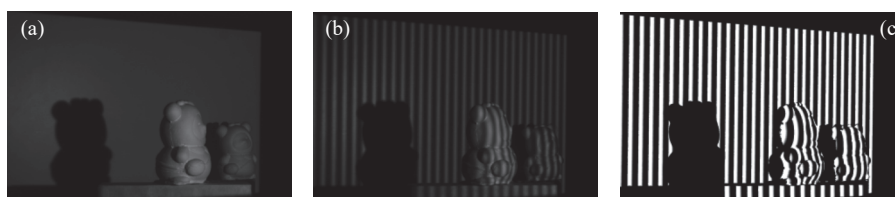
图 8 多频相位选择方法测量物体: (a) 被测物体; (b) 一幅四步相移图像; (c) 被测物体的折叠相位
