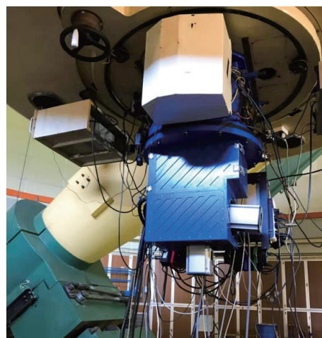
图 14 偏振光度计安装在 2.16 m 望远镜卡塞格林单元上进行观星实测
