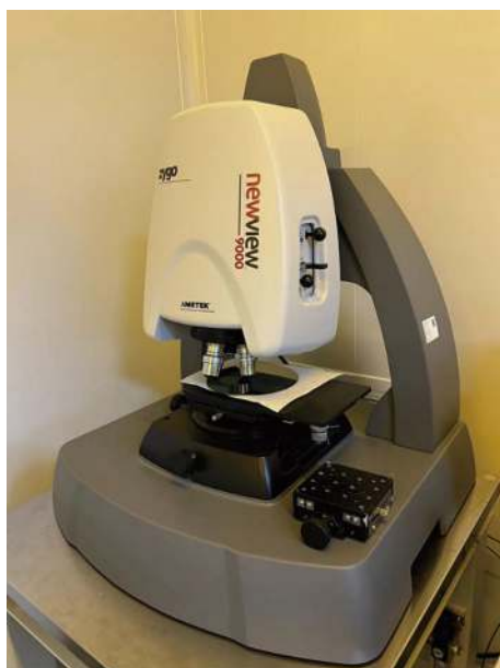
图 3 采用 Zygo 9000 白光干涉仪进行粗糙度测量
