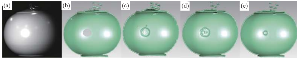
图 13 不同方法对汝窑茶叶罐的三维重建效果图。(a) 汝窑茶叶罐实物图; (b) 传统 FPP 方法; (c) Chen 的方法; (d) 詹的方法; (e) 文中方法 Fig.13 3D reconstruction effects of Ru Kiln tea caddy using different methods. (a) Ru Kiln tea caddy; (b) Conventional FPP method; (c) Chen's method; (d) Zhan's method; (e) Proposed method
