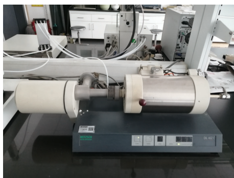
图 6 热膨胀测试仪 (DIL402 型)
