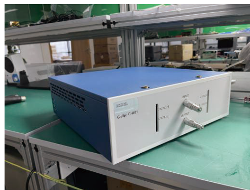
图 19 热排散系统实物
