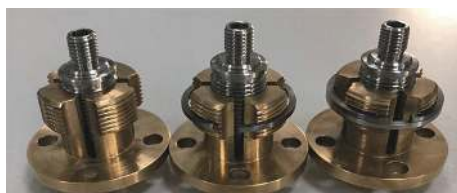
图 6 切口螺母于螺纹导杆配合
