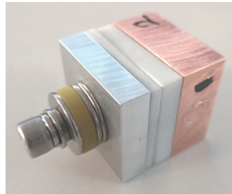
图 3 单螺栓压紧结构试验件
