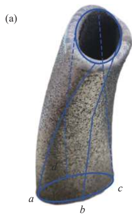
图 15 结构件实际壁厚测量。(a) 测量点取样示意图; (b) 不同位置取样的壁厚
