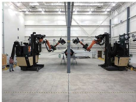
图 1 ARLCRS 对 F-16 战斗机进行激光除漆 [14]
