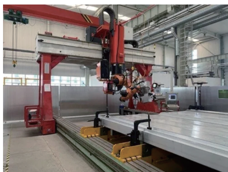
图 4 激光清洗复合焊接全自动机器人 [35]
