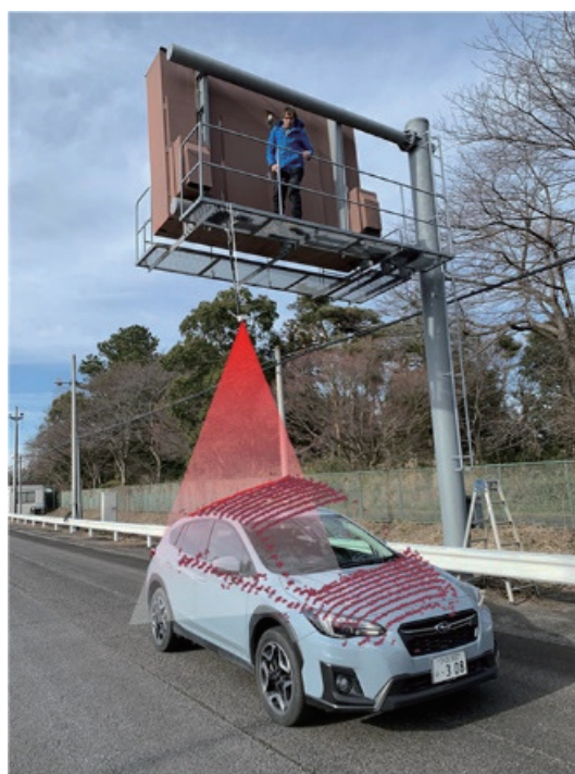
图 13 ToF 相机应用于移动车辆检测 [14]
