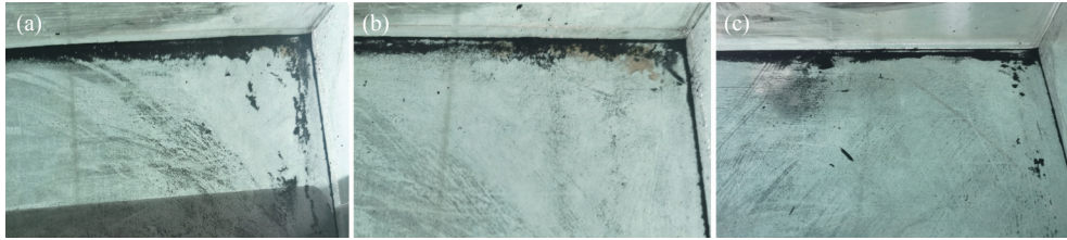
图 4 (a) 石墨沉降图像; (b) 碳纤维沉降图像; (c) 石墨烯沉降图像
