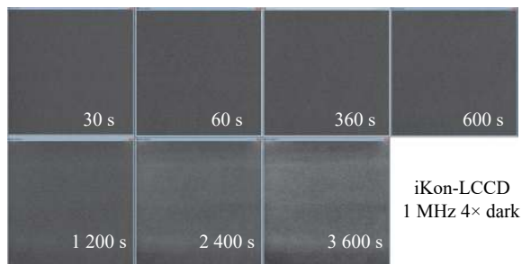
图 13 CCD 1 MHz 4×档位暗电流变化情况
