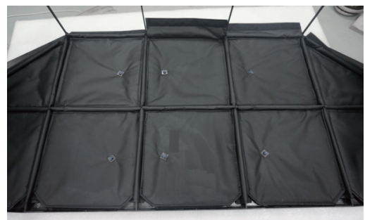
图 7 遮光罩内部覆盖 MLI 状态
