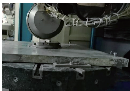
图 2 磁流变修复损伤实物图
