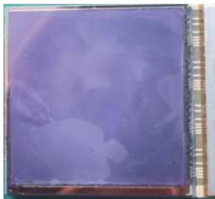
图 8 SW 2 k×2 k(18 μm) 碲镉汞红外焦平面探测器件
