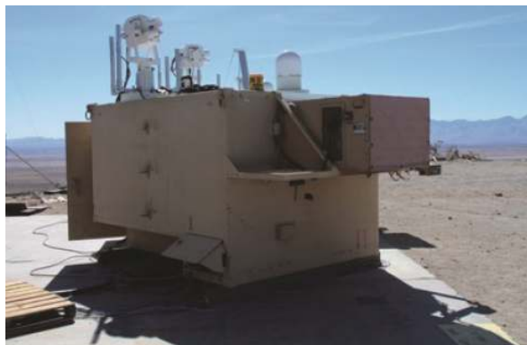
图 4 FOENEX 链路地基节点(安装了 2 套激光终端,1 套射频终端)
