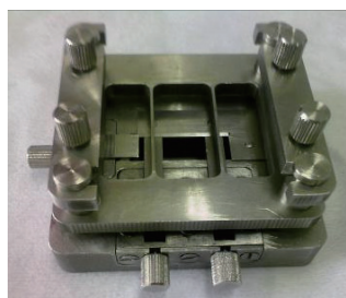
(b) 粘接工装实物 (b) Photos of bonding tooling
