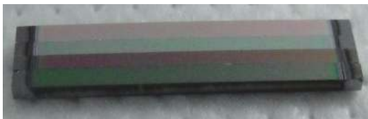
图 8 4 通道短中波红外长阵拼接集成滤光片实物照片
