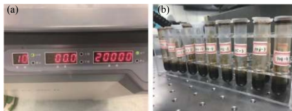
图 4 (a) 离心机示意图; (b) 离心后的原油样品图
