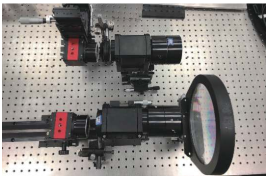
图 6 双通道系统实验装置
