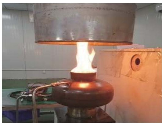
图 4 标准火焰测试台架
