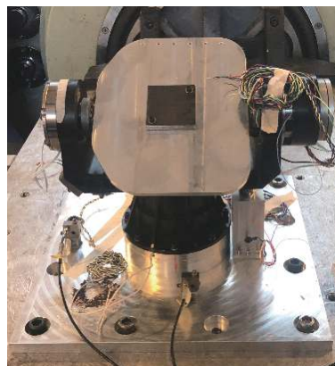
图 13 二维转台模拟样机力学试验
