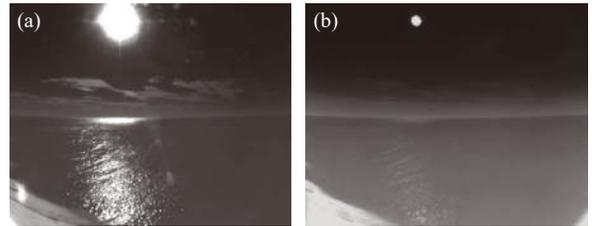
图 5 中、长波热像仪对太阳、云层、海面成像的对比试验图。(a) 中波;(b) 长波
