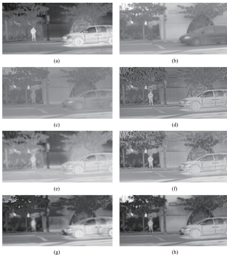
图 5 RoadScene 数据集对比实验结果。(a) 红外图像;(b) 可见光图像;(c) DRTV;(d) CNN;(e) FusionGAN;(f) DIDFuse;(g) DDcGAN;(h) 文中方法
