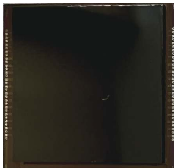
图 14 长波 256×256 数字像元红外焦平面探测器芯片
