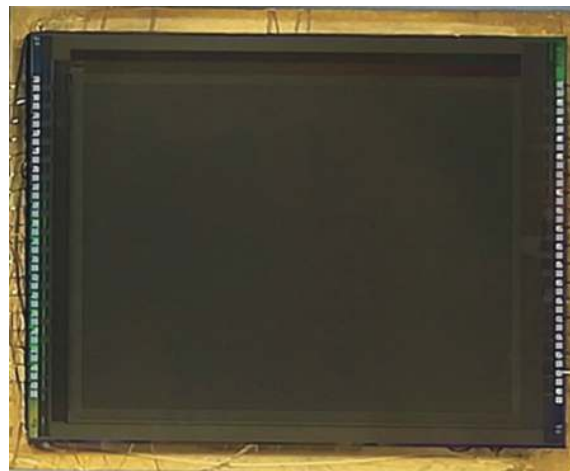
图 13 长波 384×288 数字像元红外焦平面探测器芯片
