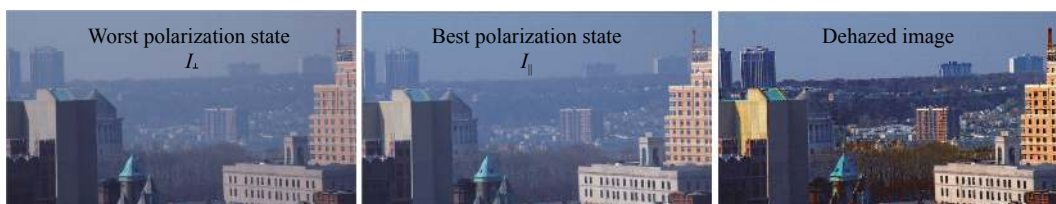
图 36 采用两张正交偏振图像进行图像去雾的效果 [27]
