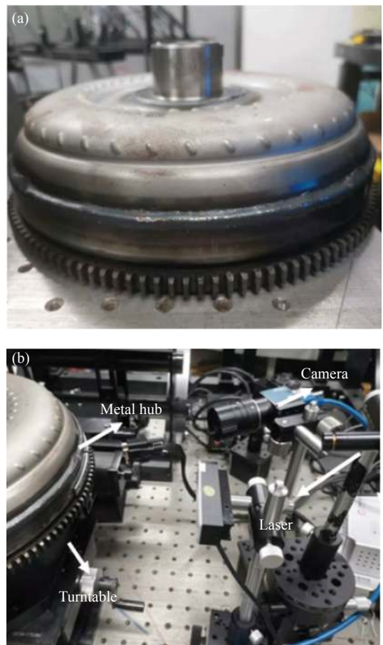
图 7 (a) 被测金属轮毂实物图; (b) 实验图
