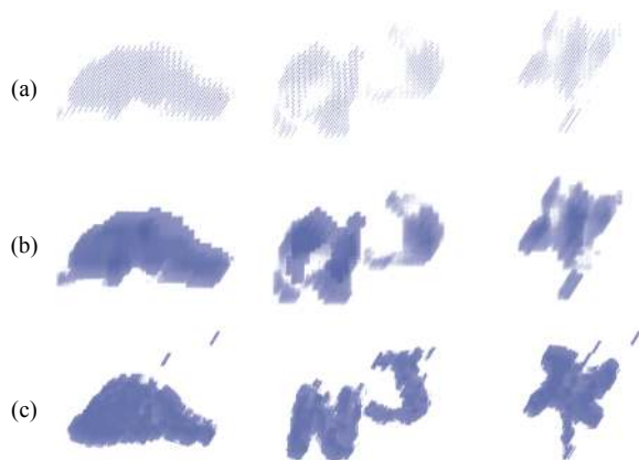
图 5 (a) 没有上采样的点云图; (b) 使用后上采样法的点云图; (c) 使用预上采样法的点云图
