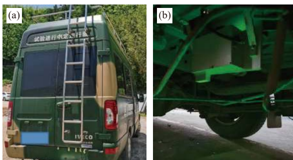
图 8 跑车试验用车及测速仪安装图
