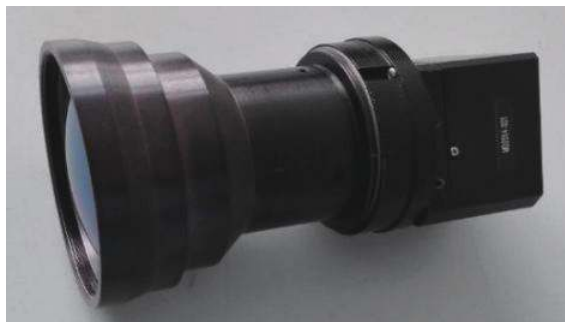
图 4 ZnSe 相位板的波前编码红外成像系统 [27]
