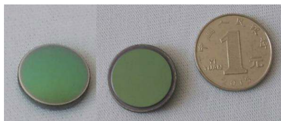
图 12 宽视场波前编码红外成像系统中双面型光学相位板的非球面(图左)和三次面(图中) [23]
