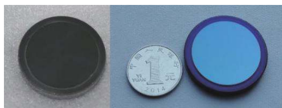
图 8 锗材料相位板。(左) 未镀膜;(右) 镀膜后 [26]
