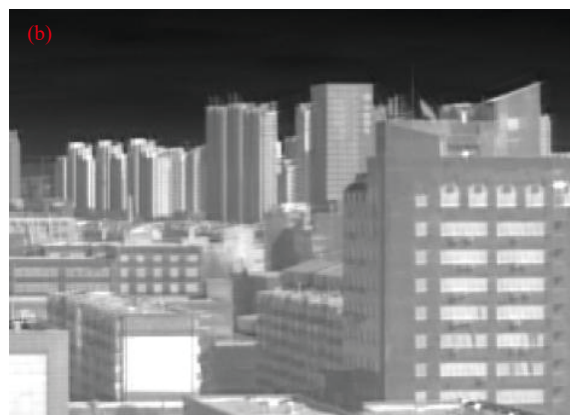
图 9 波前编码红外成像系统样机 (含锗材料相位板) 的常温实验结果 [25]
