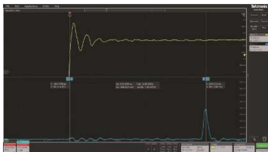
图 3 激光发射同步信号与回波信号对比图
