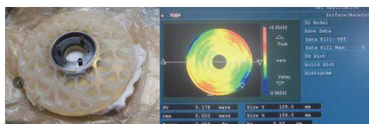
图 11 主镜组件面型检测结果图
