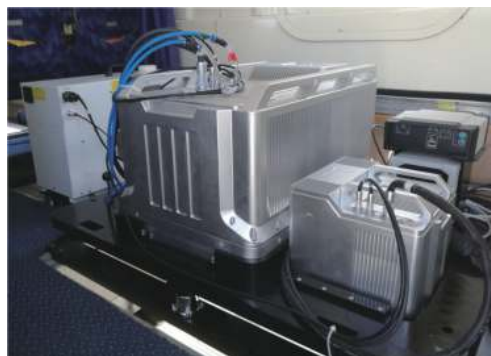
图 1 机载双频激光雷达 Mapper 5000 系统
