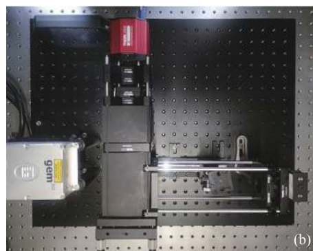
图 3 近 180° 水体体积散射函数测量系统原理图 (a) 和实物模型 (b)
