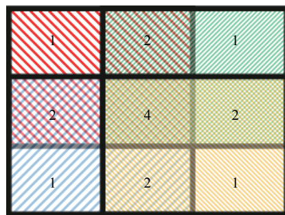
图 3 4 孔径视场重叠示意
