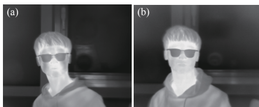
图 14 高低温成像图片。(a) 低温 -40 ^{\circ}\text{C} 图像;(b) 高温 60 ^{\circ}\text{C} 图像
