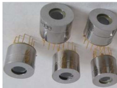
图 9 华沙军事技术大学势垒型碲镉汞单元器件样品
