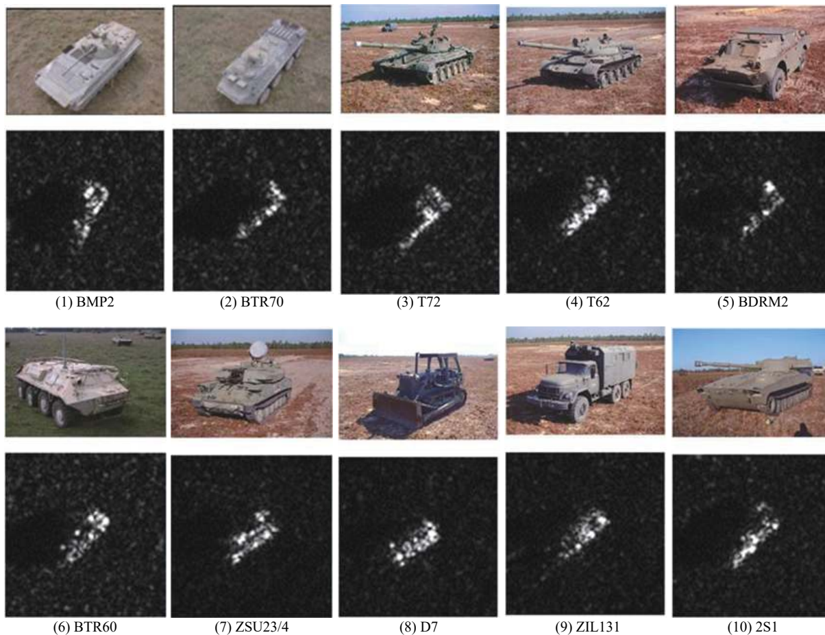
图 2 10 类 MSTAR 目标的光学及 SAR 图像
