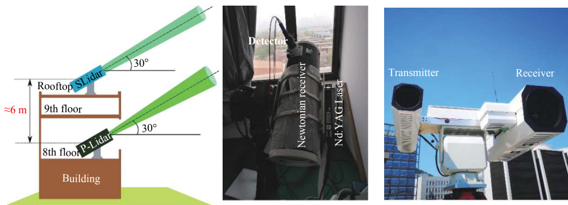
图 4 (a) 对比测量示意图, (b) 脉冲激光雷达系统的实物图, (c) SLidar 系统实物图。防雨 SLidar 系统放置在楼顶, 脉冲激光雷达系统位于实验室内部
