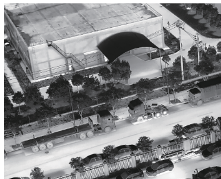
图 5 T2 条件下制备氧化钒薄膜制成的探测器成像图
