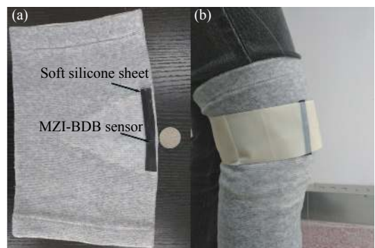
图 2 (a) 传感器封装示意图; (b) 传感器封装、固定膝关节示意图
