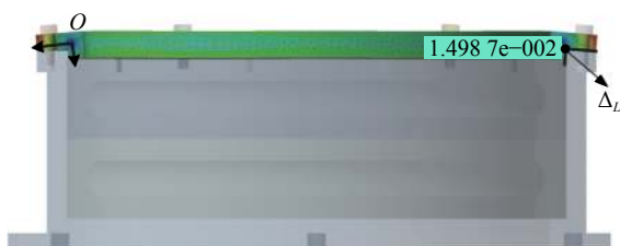
图 8 10 倍放大后的轴承外压圈变形云图
