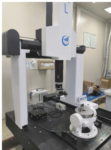
图 12 测量量块厚度
